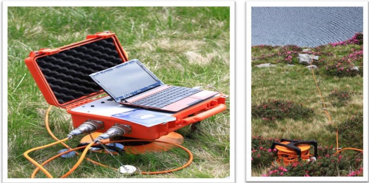
Fig. 1.3.8. GeoTom (Geolog 2000) and Multi-core wires.
